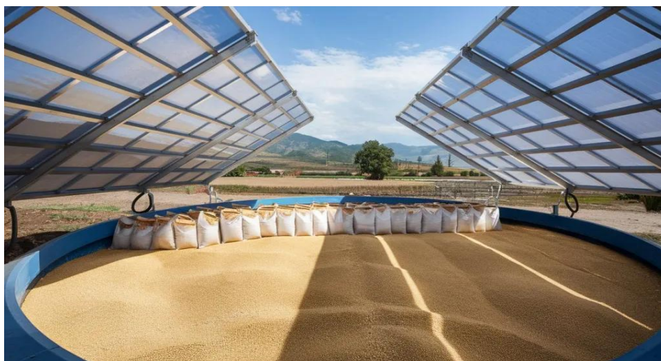
Imagem 8. Secador solar de cereais (Saini et al., 2023)
